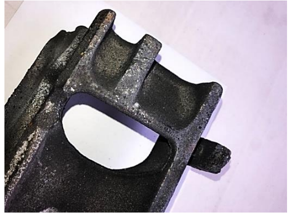
Рис. 2. Дефект в виде засора
