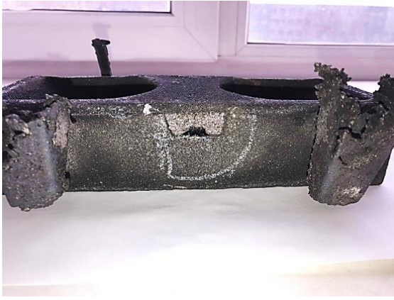
Рис. 1. Дефект в виде усадочной раковины
