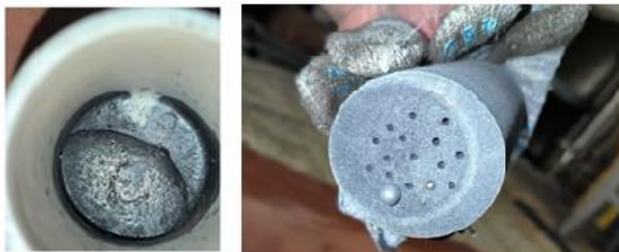
Рис. 3. Металл, прошедший через слой кокса и накопленный в керамическом тигле (слева) и дно графитового тигля с каплями металла (справа)
