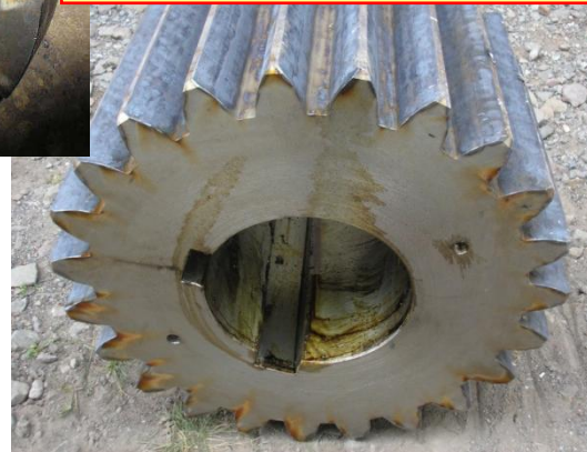
Зубья шестерни подвенцовой, сталь 45 (до 55 HRC)
