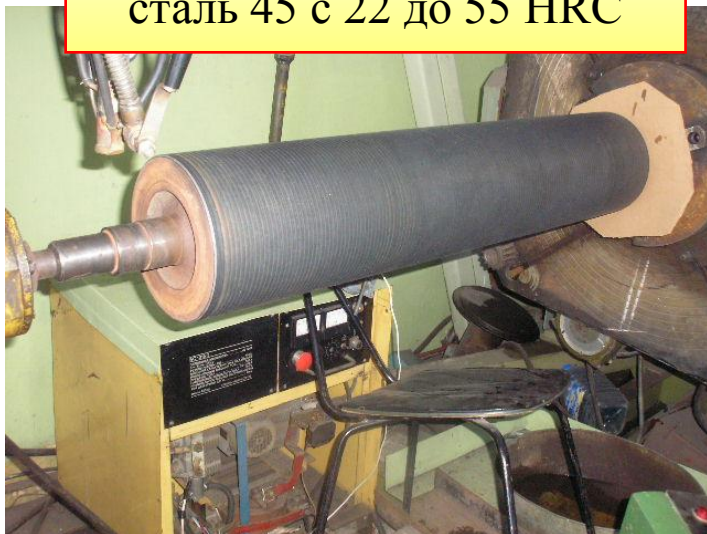
Вал пустотелый, сталь 45 с 22 до 55 HRC
