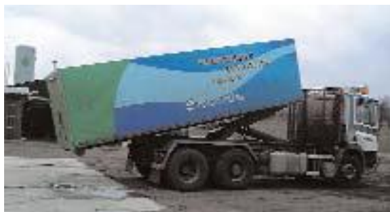
Фото 4. Саморазгружающийся контейнеровоз с контейнером газовых баллонов
