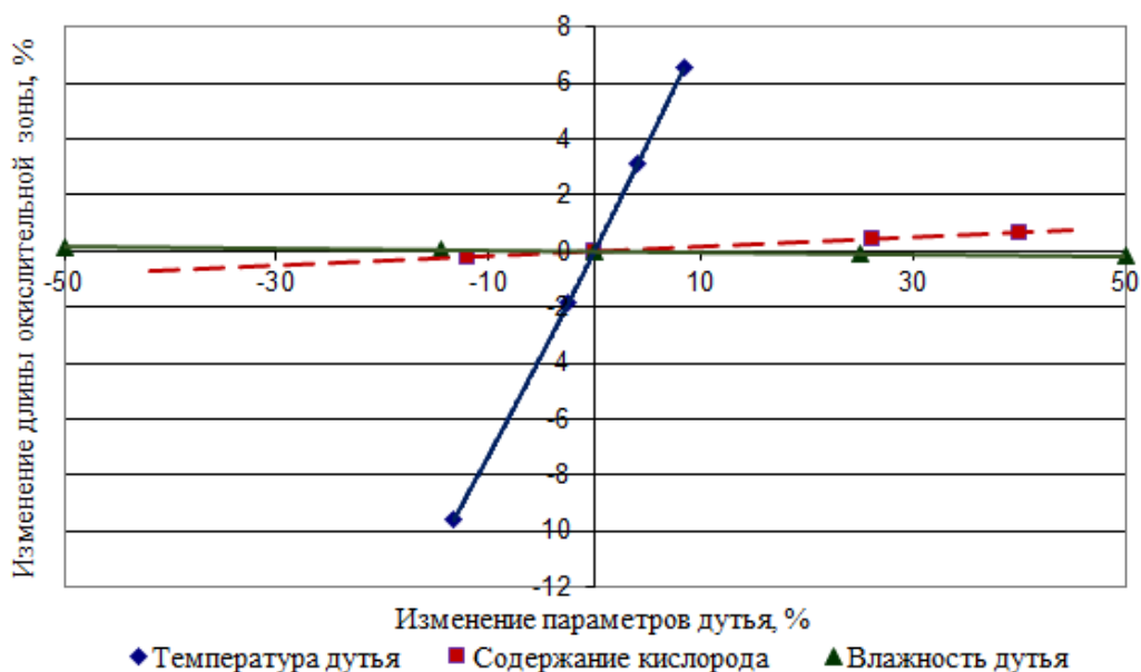
Рисунок 4. Влияние изменения параметров дутья на изменение длины окислительной зоны
