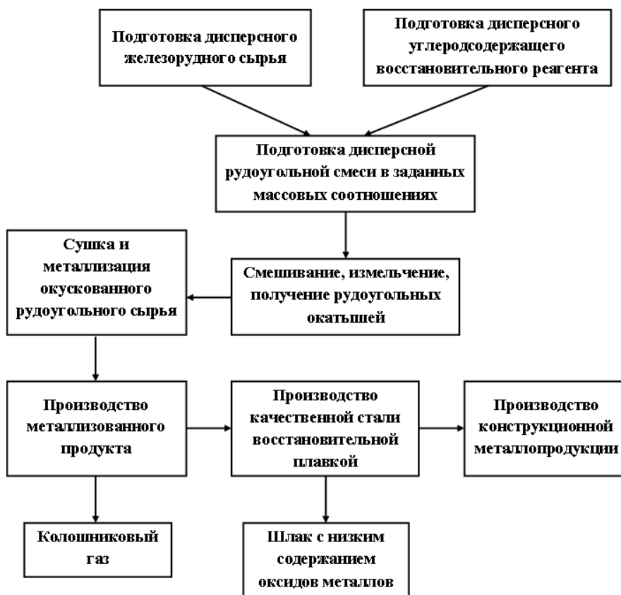
Рис. 2. Схема перспективной одностадийной непрерывной технологии производства стали
