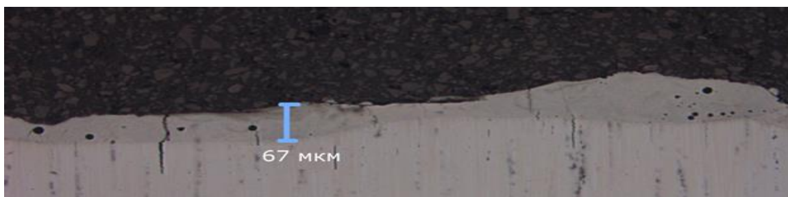
Рисунок 2. Покрытие после лазерной обработки, образец 1А
