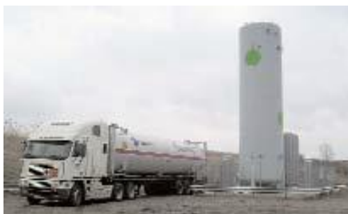
Фото 1. Автомобильный контейнеровоз с контейнером-цистерной модели КЦМ-35/0,6 прибыл к месту слива СПГ (г. Лингчепинг, Швеция, 13 апреля 2006 г.)
