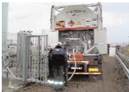
Фото 5. Слив сжиженного природного газа из емкости контейнера-цистерны КЦМ 35/0,6 в стационарное хранилище
