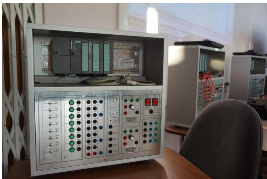
Рисунок 1. Стенд на базе ПЛК S7-300
