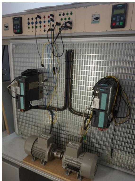
Рисунок 3. Стенд на базе электроприводов Sinamics
