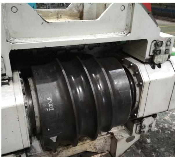
Рис.2. Валок, изготовленный по экспериментальной 3-D модели
