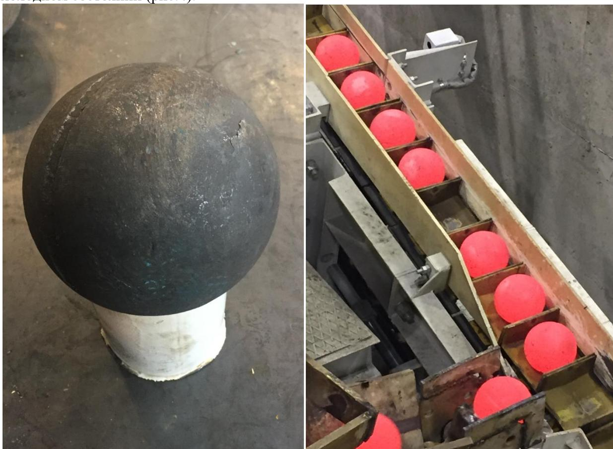
Рис.4. Шары, полученные на экспериментальной калибровке
