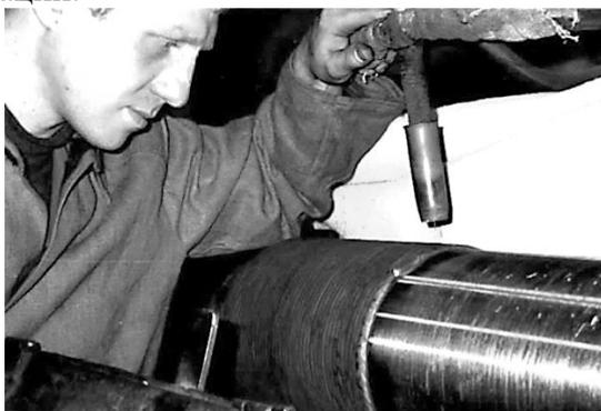
Рис. 2. Выпускник НТИ УрФУ, Чубелов В. выполняет настройку наплавки ролика МНЛЗ; фото середины 90-х годов.
