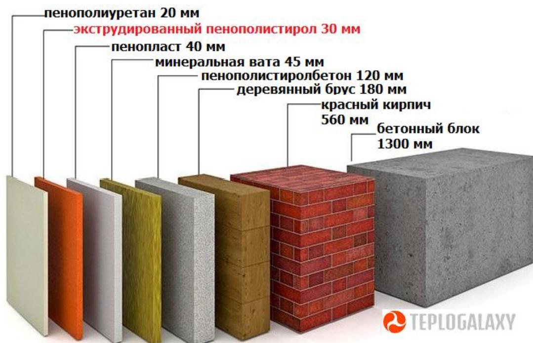
Рис.1. Схема сравнения теплоизоляционных свойств различных строительных материалов-утеплителей
