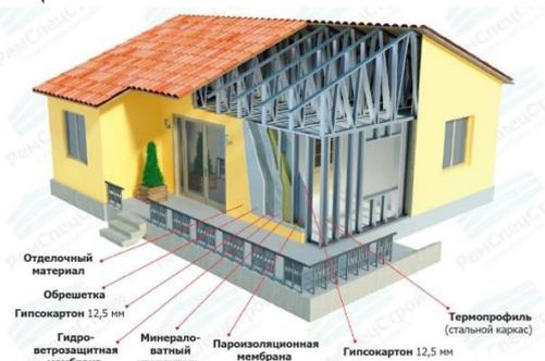
Рис.1. Устройство металлокаркаса дома из ЛСТК
