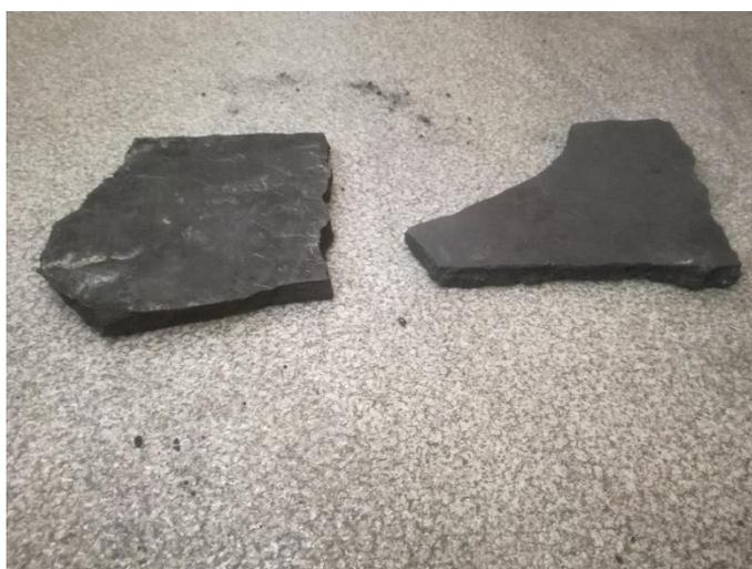
Рис. 2 Образцы углеродистого блока с района чугунной летки №2
