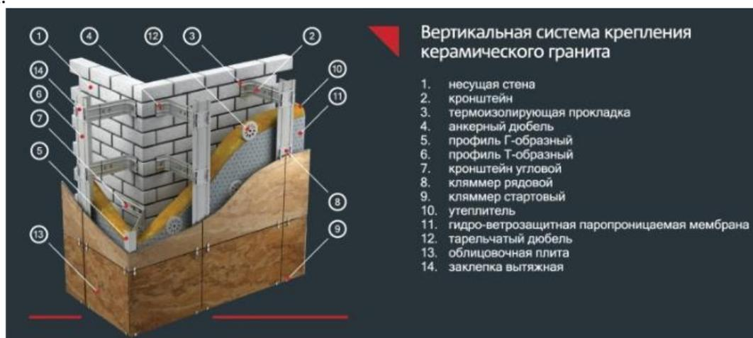
Рис. 2. Конструкция вентфасада.
