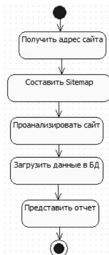
Рис. 1. Диаграмма состояния «Процесс парсинга»
