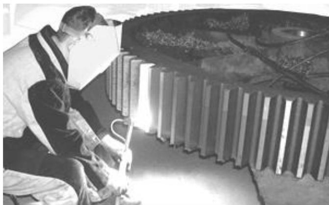
Рис. 2. Плазменная закалка установкой УДГЗ-200
