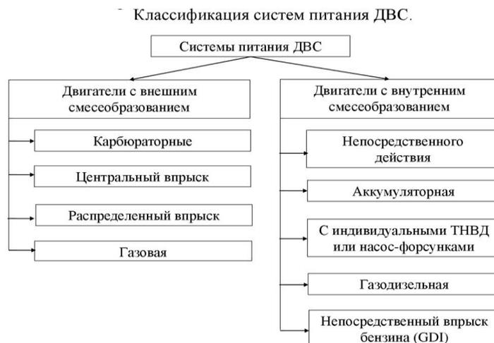
Рис. 1. Классификация питания двигателей внутреннего сгорания
