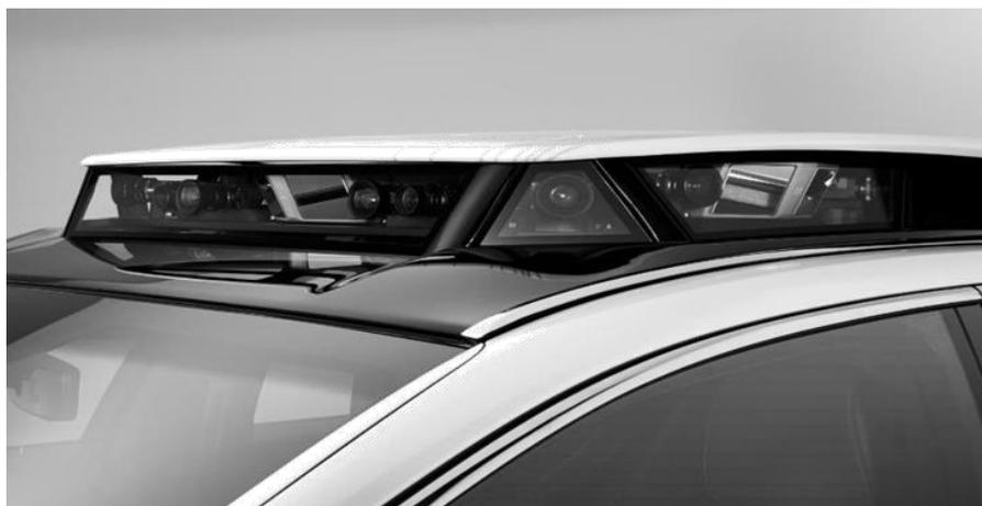
Рис. 2. Дополнительные датчики беспилотного Lexus P4
