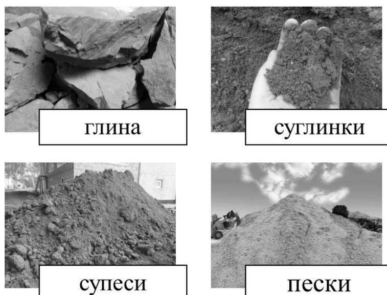
Рис. 2. Грунты для использования метода режущего кольца
