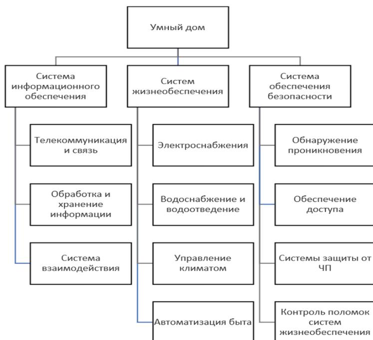
Рис. 3. Декомпозиция функций системы «умный дом»
