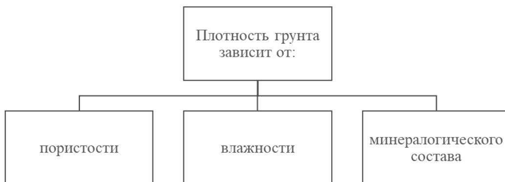
Рис. 1. Зависимость плотности грунта
