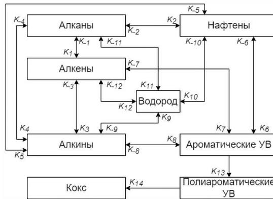
Рис. 1. Формализованная схема превращений
