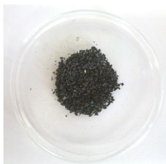
Рис. 1. Катализатор для синтеза метанола CuO-ZnO-Al 2 O 3 (66:17:17)
