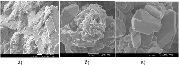
Рис. 1. Микрофотографии проб фосфогипса при различном разрешении: а) 1000; б) 2500; в) 3000
