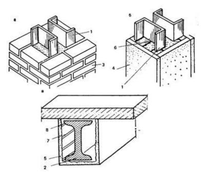
Рис. 1 Защита металлических конструкций малотеплопроводными материалами. а – кирпичом; б – гипсовыми плитами; в – штукатуркой; 1 – стальная колонна; 2 – стальная балка; 3 – кирпич; 4 – гипсовая плита; 5 – штукатурка; 6 – анкер; 7 – арматурный каркас; 8 – объемная сетка
