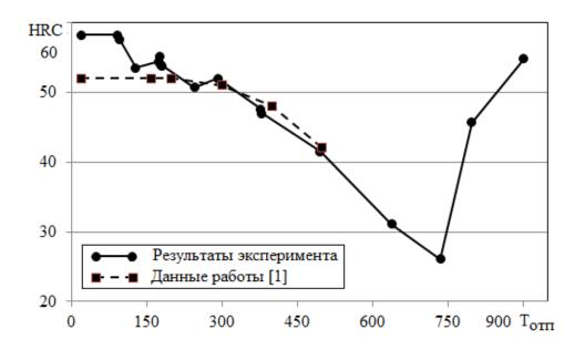
Рис. 1. Влияние температуры отпуска на твердость стали 38ХС.
