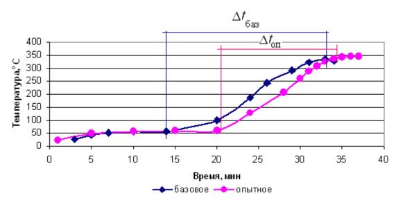
Рис. Изменение температуры отходящих газов
