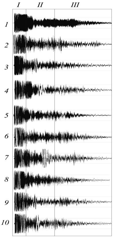
Рис. 3. Графики звуковых колебаний закаленных шаров. (I - зона атаки звука, II - зона накопления гармонических колебаний, III - зона затухания колебаний), цифры 1...10 номера режимов испытуемых шаров
