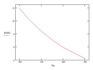
Рис. 1. Результаты вычисления температурной зависимости (температура в K) равновесного давления (Па) диоксида серы в газовой фазе после взаимодействия с поглотительным раствором (начальное давление равно 1013 Па)
