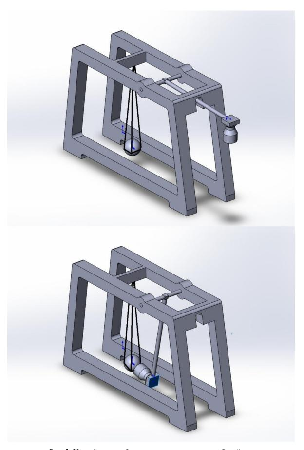
Рис. 2. Устройство возбуждения акустических колебаний от шаров.
