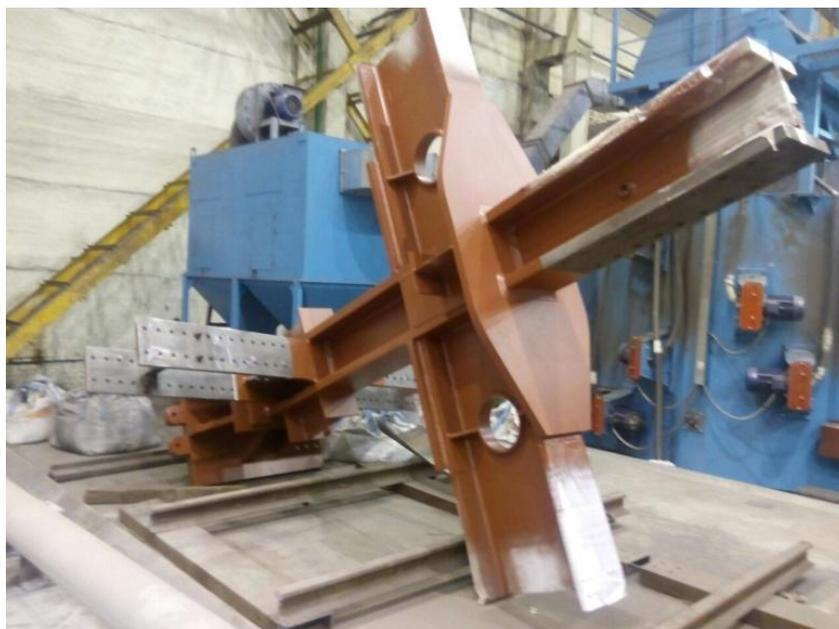
Рис.3. Готовая к отгрузке колонна для объекта «Многофункциональный центр ЛАХТА» г. С-Петербург
