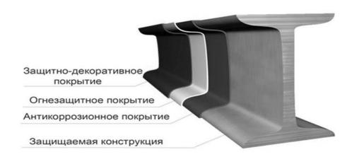
Рис. 2 Послойная защита металлоконструкций.
