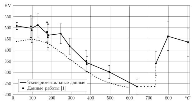
Рис. 1. Влияние температуры отпуска на среднюю микротвердость стали 20
