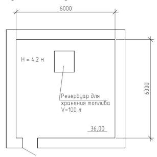
Рис.1. Геометрические параметры помещения.
