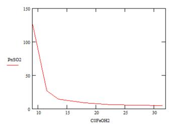
Рис.2. Зависимость парциального давления диоксида серы после обработки поглотительным раствором от концентрации в нем  $Fe(OH)_2$  (давление в  $\Pi a$ ; концентрация в  $r/m^3$ ). Начальное парциальное давление диоксида серы 1013  $\Pi a$ .
