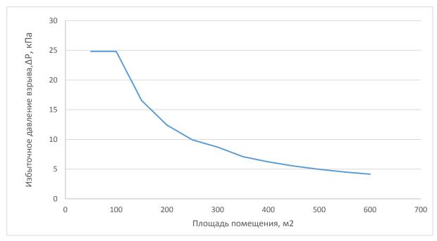
Рис. 2 - График изменения избыточного давления взрыва
