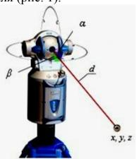
Рис. 1. Принцип работы лазерного трекера
