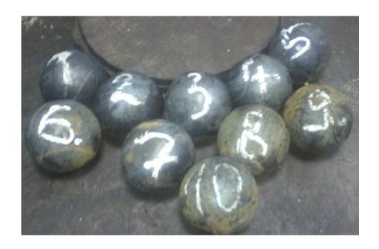
Рис. 1. Пария шаров Ø60 с разными режимами закатки и самоотпуска
