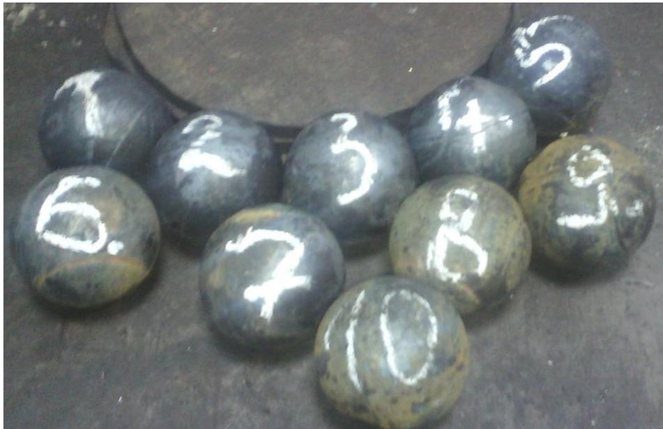
Рис. 1. Пария шаров  $\varnothing 60$  с разными режимами закатки и самоотпуска
