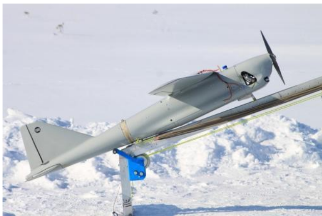
Рис. 3. БЛА «Орлан-10». Комплекс с БЛА Орлан-10 позволяет контролировать протяженные объекты в труднодоступной местности. Может использоваться для спасательно-поисковых работ.
