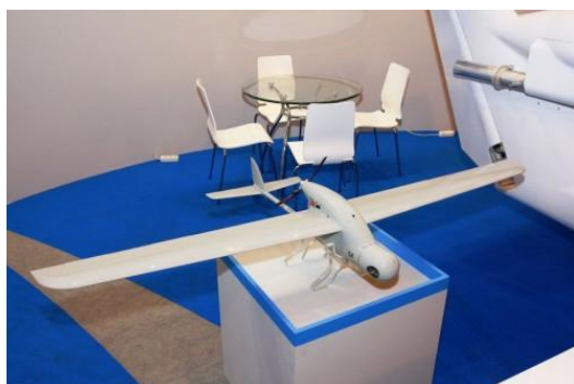
Рис. 1. Беспилотный аппарат ИРКУТ-3. Выполняет задачи круглосуточного мониторинга в широком диапазоне метеоусловий.
