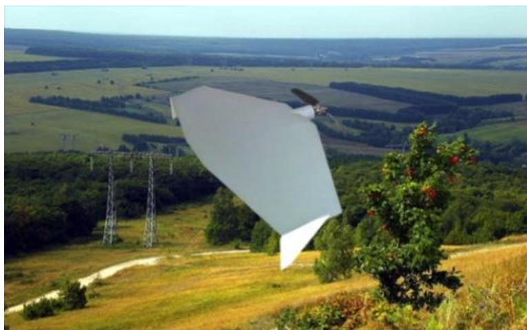
Рис. 2. Беспилотный комплекс Supercam 100. Специальный комплекс дистанционного мониторинга на базе БЛА самолетного типа.
