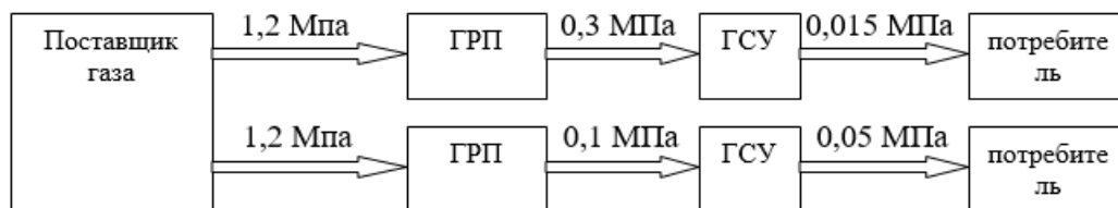
Рис. 4. Условная схема распределения давлений природного газа на АО «ЕВРАЗ НТМК»
