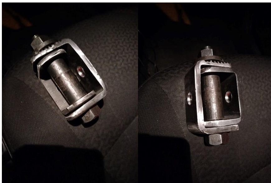
Рис. 5, 6. Изготовленный первый экземпляр подвижного шарнира
