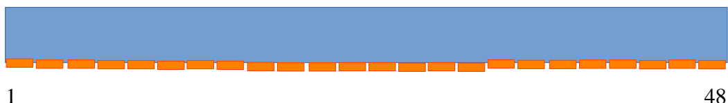
Рис. 1. Пример фазированной решетки из 48 элементов
