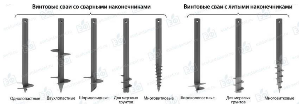
Рис. 1. Виды стальных винтовых свай
