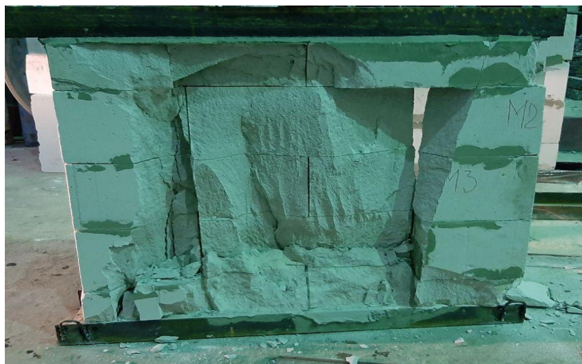
Рис. 5, а. Характер разрушения эталонного образца
