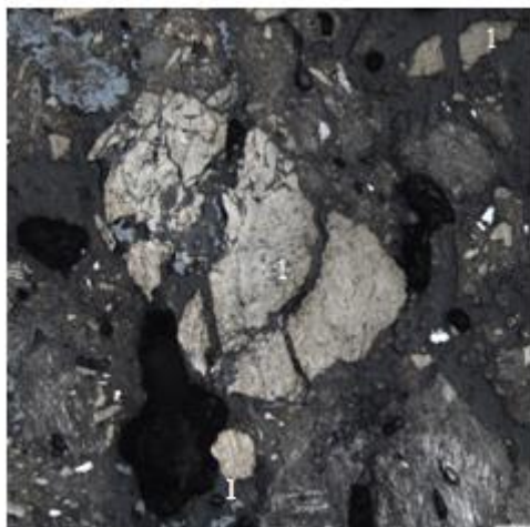
Рис. 5 Микроструктура углеродистого гарнисажа тип 3. Образец Г10.1. Свет отраженный, \times 190 . Светло-серое – первичный графит (из футеровки); темно-серое – аморфный углерод и полуграфит; ярко белые – металл (Fe + Fe 3 C); черное – стеклофаза (шлак)
