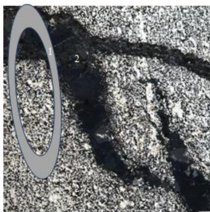
Рис. 9 Микроструктура гарнисажа типа 5 (образец Г10). Свет отраженный, \times 100 .
