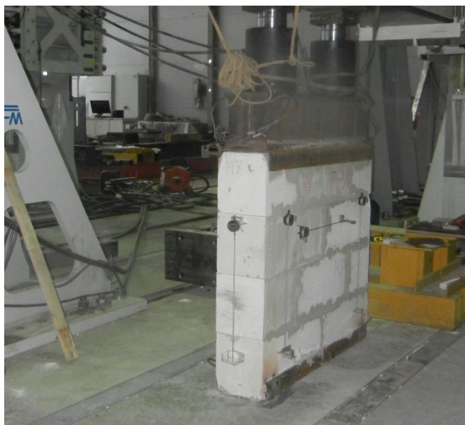
Рис. 2 Общий вид опытного образца из газобетонных блоков
