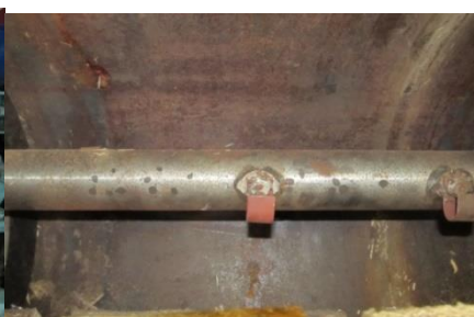
Рис. 3 Вид полого вала с отверстиями, через который проходит связующее
