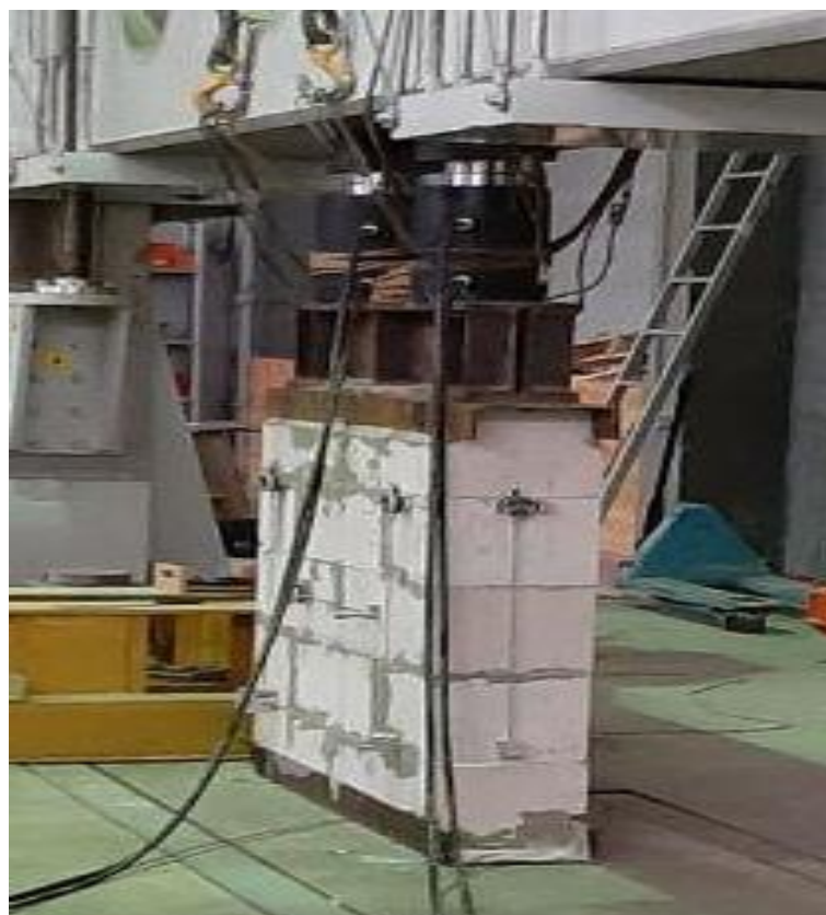
Рис. 4 Установка для испытаний опытных образцов на сжатие
