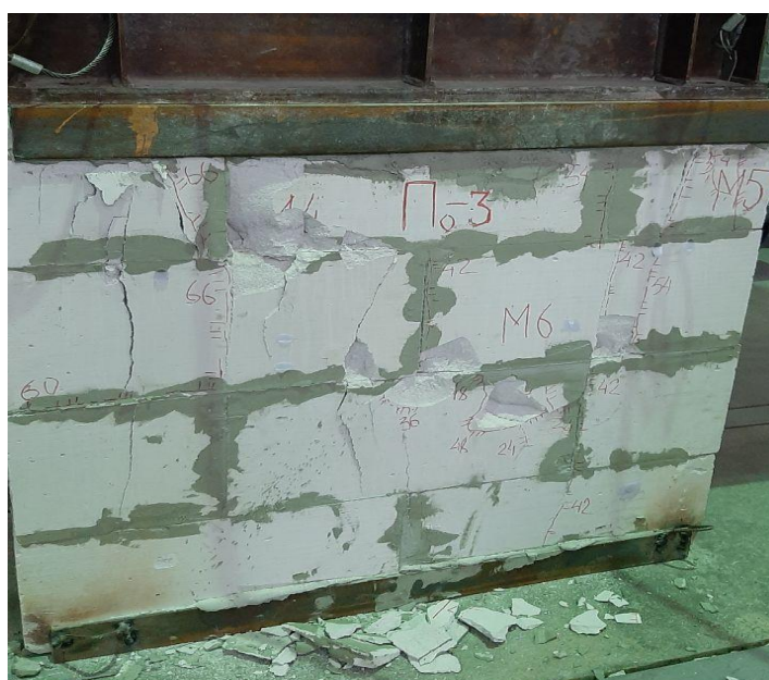
Рис. 5, б. Характер трещин в образце, армированном базальтовой сеткой
