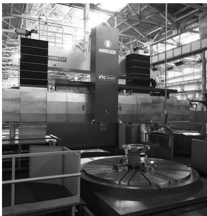
Рис. 5 Большой токарно-карусельный обрабатывающий центр с ЧПУ фирмы «Hankook» (Корея)
