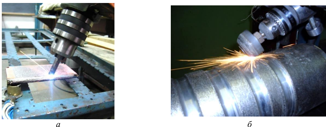
Рис. 1 Электроискровое легирование плоского (а) и цилиндрического (б) изделия
