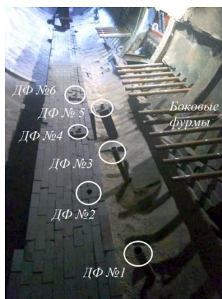
Рис. 1 Взаимное расположение донных и боковых фурм (вид с внутренней стороны футеровки)
