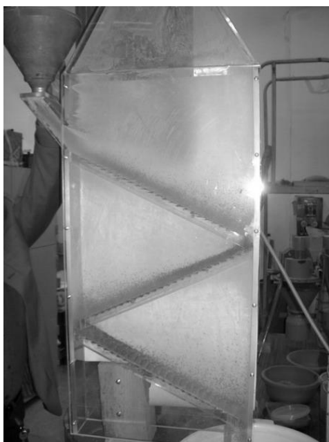
Рис. 2 Противоточные холодильники с жалюзийными решетками. Движение материала в лабораторной модели
