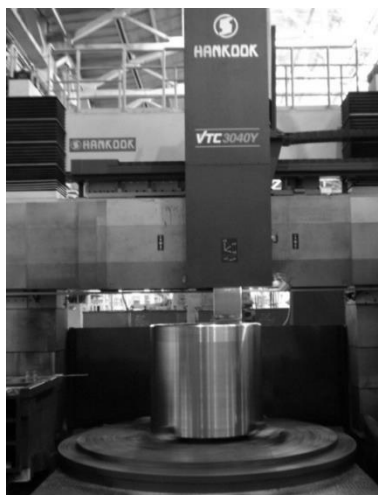
Рис. 3 Изготовление бандажей на обрабатывающем центре фирмы «Hankook» (Корея)
