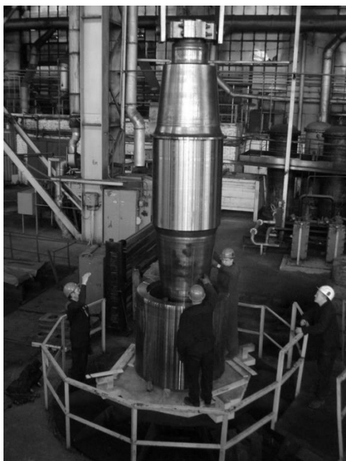
Рис. 4 Сборка составных валков на специализированном участке
