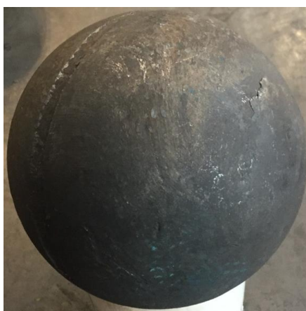
Рис. 4 Шар, полученный с опытной прокатки
