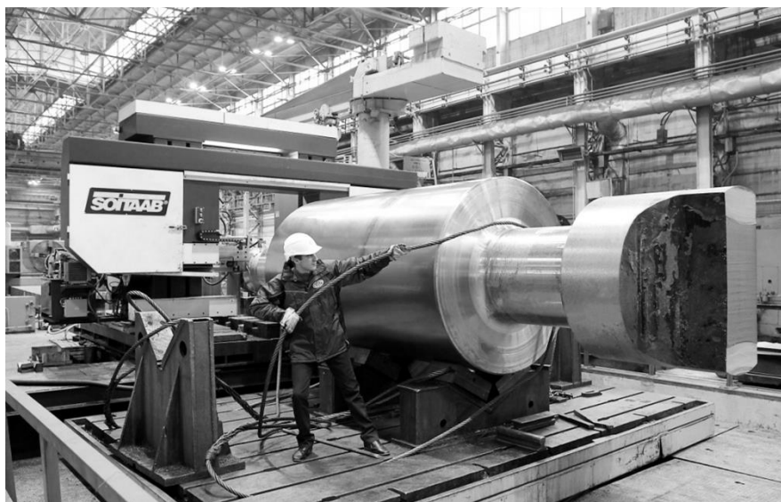
Рис. 6 Ленточнопильный станок фирмы «SOITAB» (Италия)
