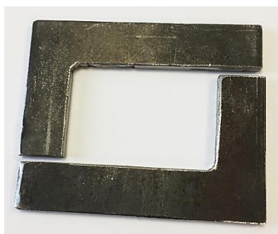
Рис. 2 Г-образные образцы для исследования твердости и магнитной проницаемости
