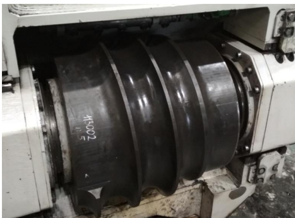
Рис. 3 Валок с постоянной шириной реборды и непрерывно-меняющимся шагом на апробации в стане
