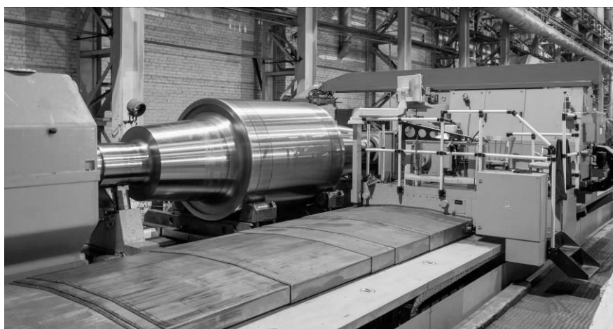
Рис. 7 Модернизированный вальцешлифовальный станок «Waldrich Siegen» (Германия)
