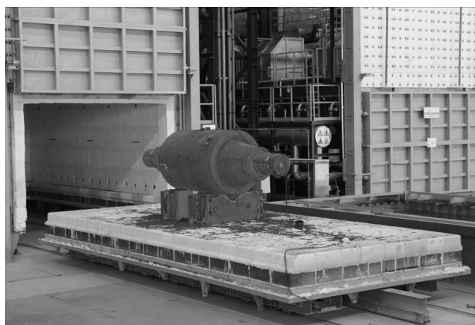
Рис. 1 Нагрев опорного валка в горизонтальной термической печи под закалку
