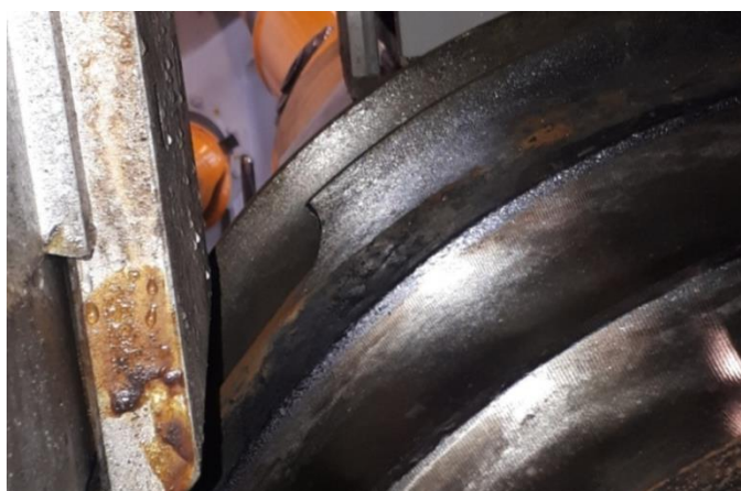
Рис. 1 Разрушение реборды валка в зоне отделения перемышки
