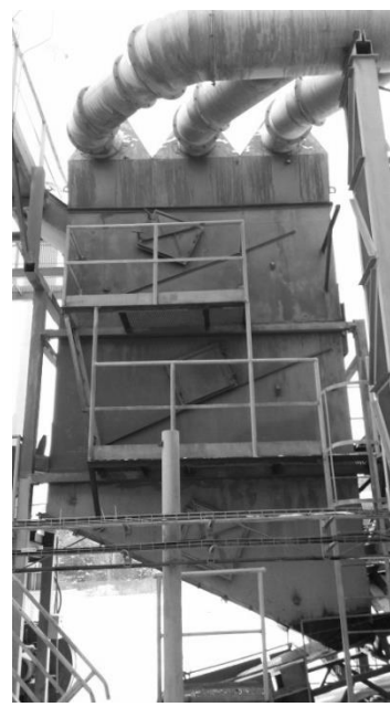
Рис. 3 Промышленный холодильник производительностью 17 т/ч
