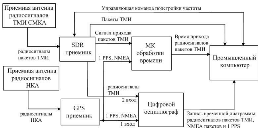
Рис. 1 Схема измерений параметров радиосигналов телеметрии СМКА
