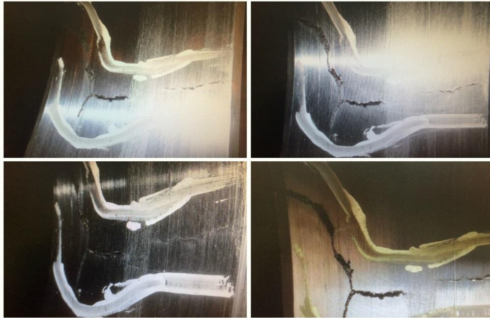
Рис. 3. Дефекты в станине ротора
