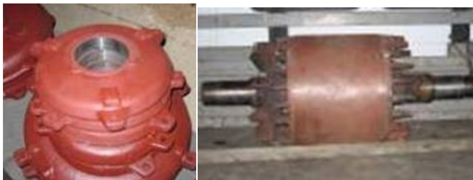
Рис. 3а. Справа, подшипниковые фланцы электродвигателей \varnothing 250 - 200 мм (ООО «Технологии наплавки и металлизации», г. Магнитогорск) и ротор электродвигателя, (ООО «Пермь-Глобалстройсервис», г. Пермь)
