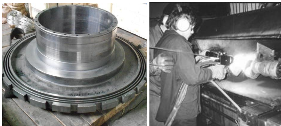
Рис. 3б. Опора станка (справа): на поверхности скольжения \varnothing 500 мм, покрытие толщиной 5 мм; (ЗАО Научно-производственное предприятие «Машпром», Екатеринбург) и (слева) напыление коленчатого вала двигателя «Камаз» (ООО «Авторемзавод», г. Красноярск).
