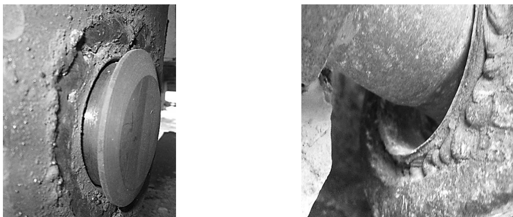
Рис.2. Износ упрочненного (слева) и неупрочненного (справа) узла подвеса борта думпкара 2ВС-105 за равный период эксплуатации
