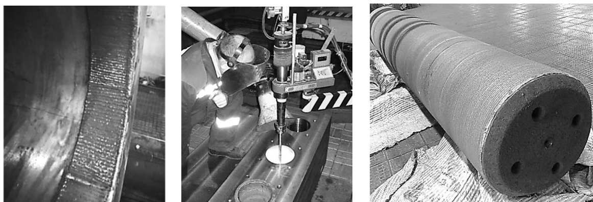
Рис. Наплавленная внутренняя поверхность цилиндра гидравлического пресса, наплавка корпуса насоса высокого давления и наплавленный плунжер гидравлического пресса (слева направо).
