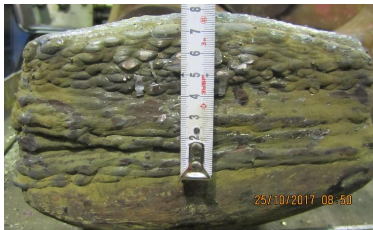
Рис. 4. Восстановление износа 80 мм
