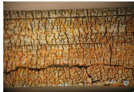
Рис. 5. Трещины, вскрывшиеся после горячего травления в поперечном сечении (а) и снаружи оси (б)
