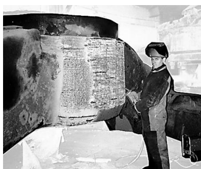
Рис. 1. Наплавка траверзы дробилки крупного дробления (а), и контактного пояса на валу дробилки среднего дробления (б)
