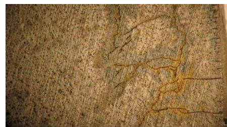
Рис. 4. Вид излома оси колесной пары
