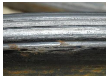
Рис. 2. Борозды (выработка металла) на гребне бандажа из-за неправильной работы тормозной колодки
