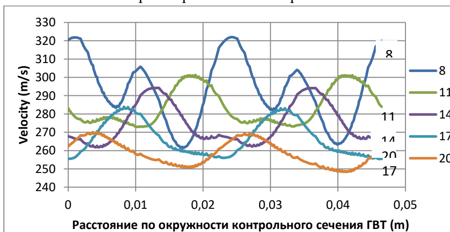
Рис. 3 Изменение скорости в контрольных сечениях 2-й расширительной камеры
