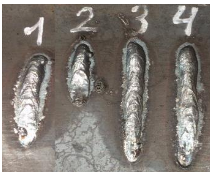
Рис. 3. Внешний вид наплавки при сварке с РПИ при балансе полупериодов: 1 – 80/20 %; 2 – 60/40 %; 3 – 40/60 %, 4 – 20/80 %
