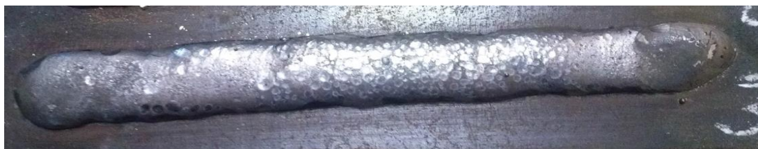
Рис. 1. Вид наплавленных валиков: а - S1,2; б - P1,2; в - SP1,2
