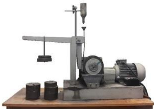
Рис. 1. Установка Бринелля-Ховарта для исследования износостойкости
