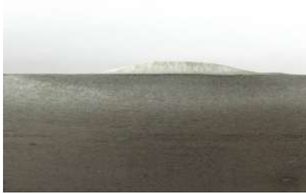
Рис. 1 Макрошлиф наплавленного валика на обратной полярности Ширина наплавленного валика за один проход может достигать 25 – 30 мм
