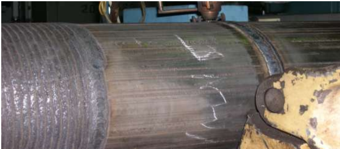
Рис. 2. Плазменная наплавка током обратной полярности оправки из стали 08X18H10, длина изделия 8 метров, диаметр 300 мм.
