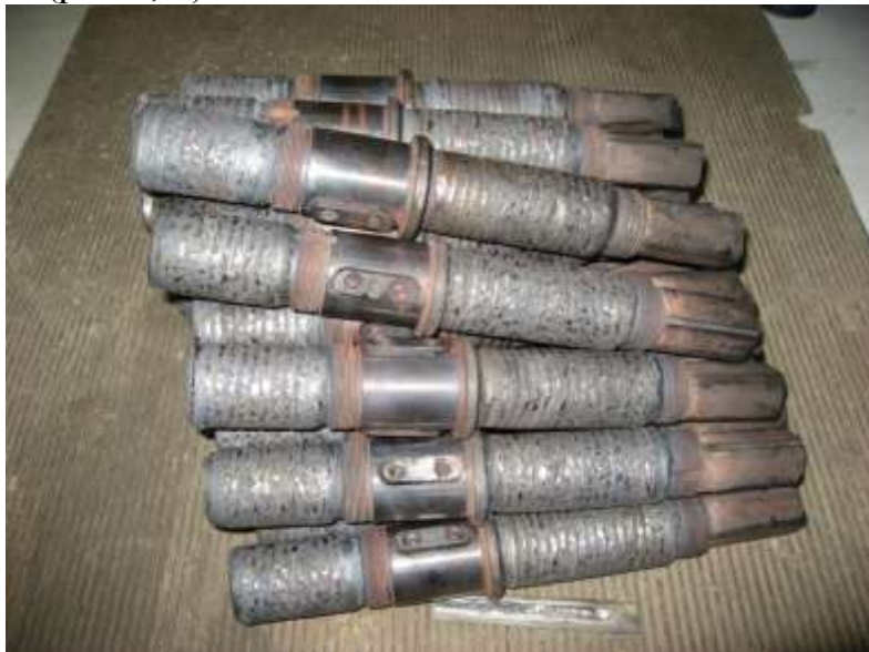
Рис. 3. Плазменная наплавка током обратной полярности валов прокатных роликов; ток наплавки 80А.
