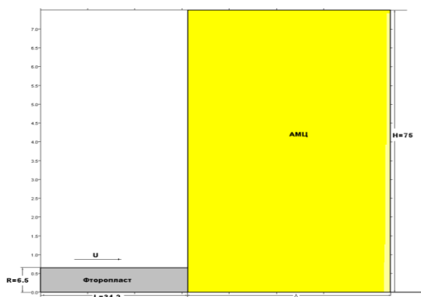
Рис. 4. Начальная постановка расчетов с преградой из АМЦ, \Delta - длина преграды (от 50 до 120 мм)
