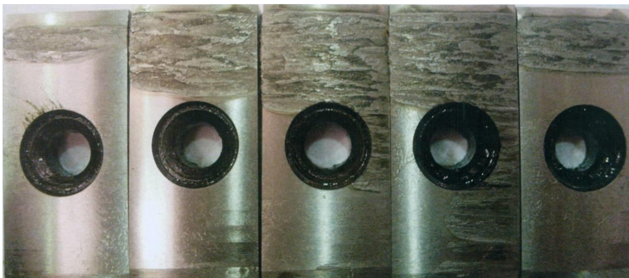
Рис. 4. Износ направляющих пластин из быстрорежущей стали. Стойкость – 100 мм.
