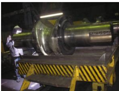
Рис. 3. Закалка трещин вала пильгерстана
