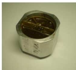
Рис. 6. Контейнер с залитым ударопрочным компаундом модулем мультиплексора аналоговых каналов
