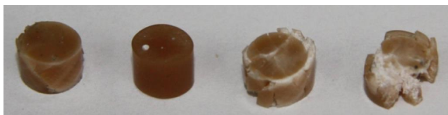
Рис. 2 Сборки из различного вида компаунда после испытаний на перегрузках 53 000 g
