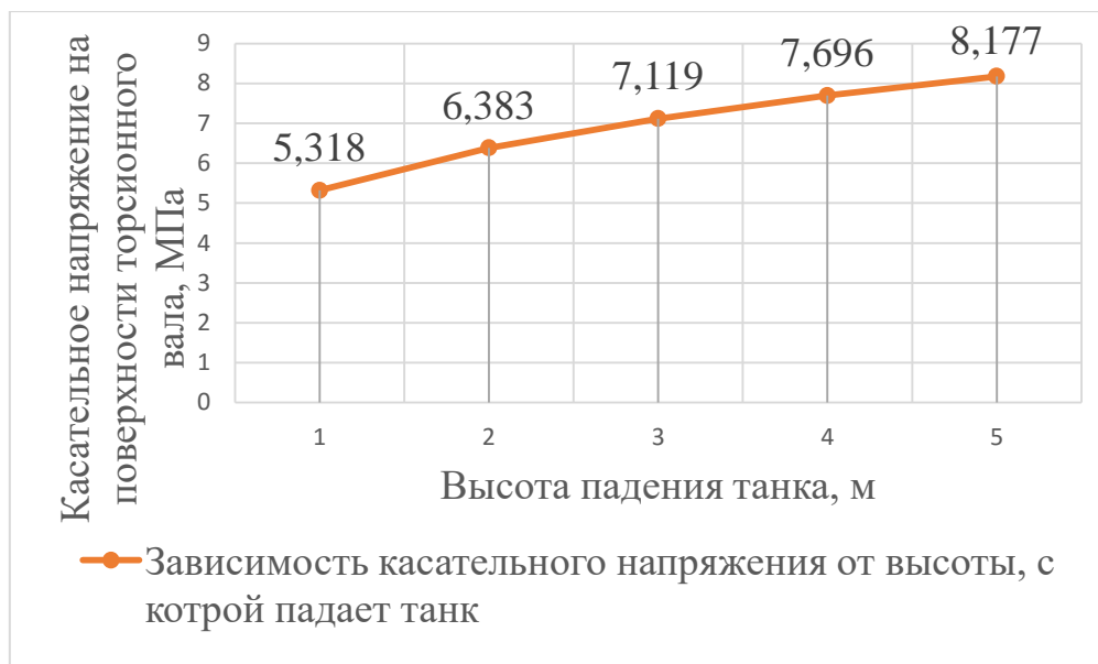
Рис. 6. Зависимость напряжения, возникающего на поверхности торсионного вала \tau_i , Мпа от высоты, с которой падает танк h , м
