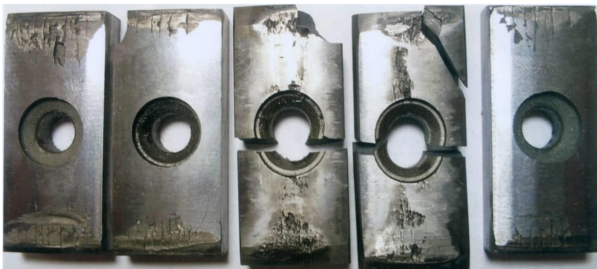
Рис. 3. Износ направляющих пластин из твердого сплава. Стойкость – 20000 мм.
