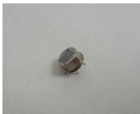
Рис.2. Passive Infrared Radiation Motion sensor - пассивный инфракрасный сенсор
