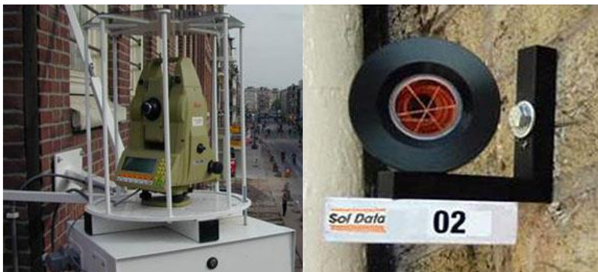
Рис. 1. Тахеометр (слева), выполняющий измерения на призмы (справа) в непрерывном режиме
