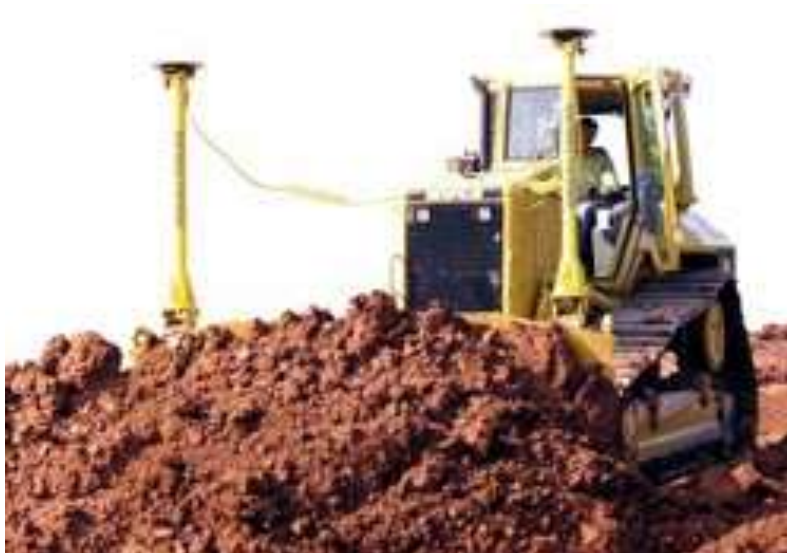
Рис. 3. Установка GPS антенны на отвале бульдозера
