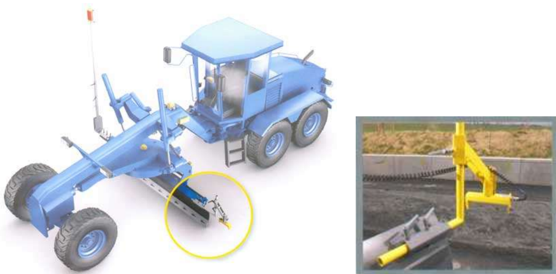
Рис. 1. Ультразвуковой датчик, установленный на отвале автогрейдера
