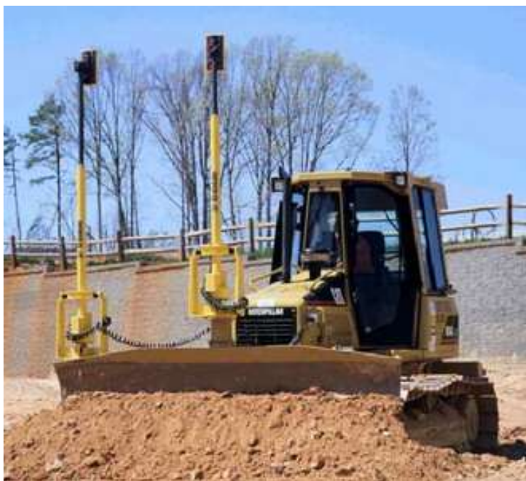
Рис. 2. Автоматическая лазерная система на отвале бульдозера
