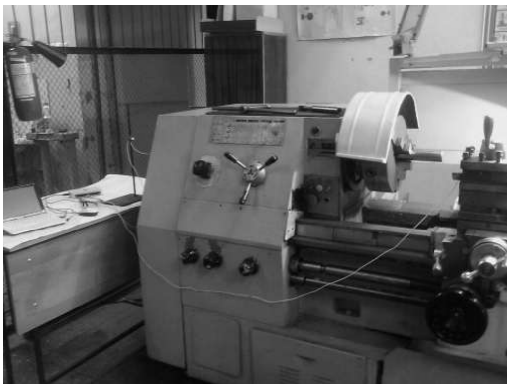
Рис. 3. Установка для исследования термоЭДС в зоне резания
