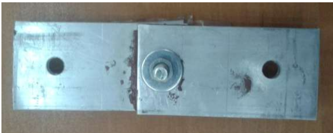
Рис. 2. Соединение №2 с нанесенной смазкой «Суперконт»
