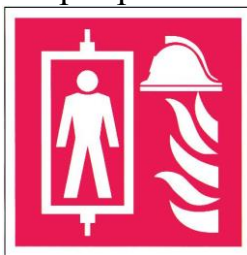
Рис.1 Маркировка шахты лифта для пожарных
