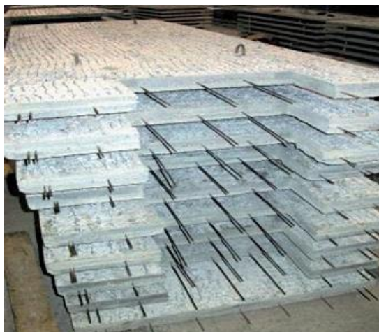
Рис. 2. Плиты – несъемная опалубка
