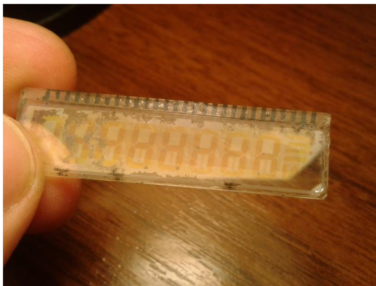
Рис. 4. ЖК-дисплей после воздействия электрического поля высокой частоты
